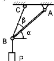
2. Груз весом  $P = 10 \text{ Н}$  подвешен на двух тросах АВ и ВС, составляющих с горизонтальной прямой углы  $\beta=15^\circ$  и  $\alpha=30^\circ$ . Определить усилия в тросах.
